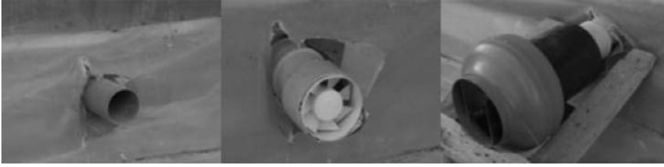
Şekil 1. Araştırmada kullanılan farklı kapasitedeki fanların görüntüsü. Solda: 95 m 3 /h Ortada: 305 m 3 /h Sağda: 990 m 3 /h
