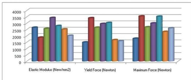
**Fig 6.** The elastic modulus, yield force and maximum force values of expandable group**Şekil 6.** Ekspansize olabilen grubun elastik modulusu, akma kuvveti ve maksimum kuvvet değerleri
