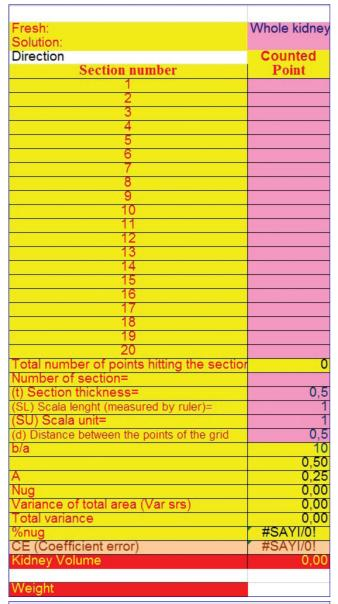
**Fig 3.** A macro program prepared using Microsoft Excel (XP) **Şekil 3.** Microsoft Excel (XP sürümü) programı kullanılarak hazırlanmış olan makro program
